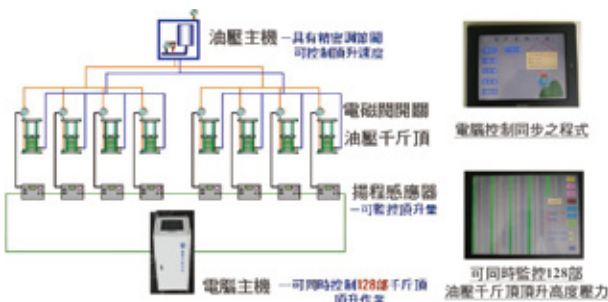
圖 3 電腦控制千斤頂系統
