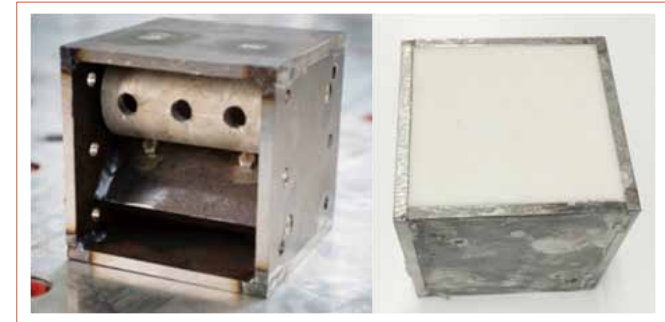
圖 6 黏彈接頭之實體照片 (a) 未填充高分子材料前，(b) 填充高分子材料後。
