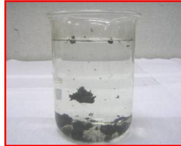
PH調整、初期污泥凝集沉降，固液分離。
