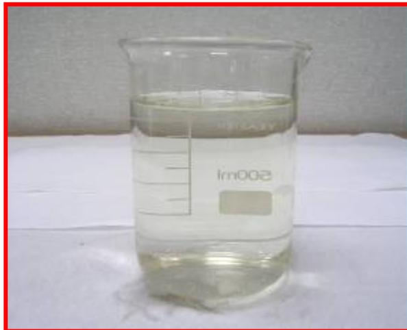
三級處理(上澄液砂濾槽/薄膜過濾SS)使水質澄清。
