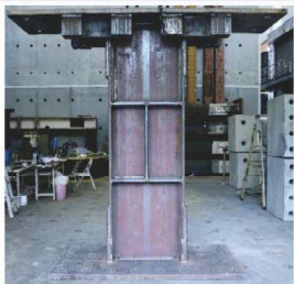
圖 6 CSPD 試體照片，上下兩端板為實驗安裝用
