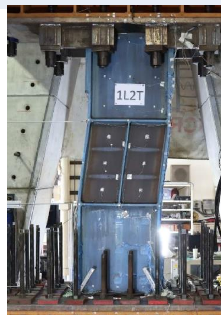
圖 7 CSPD試驗照片 (IDR=5%)
