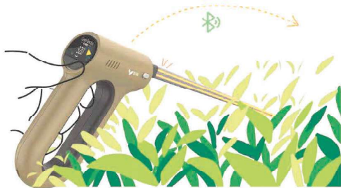
前端探入枝葉間後，按壓按鈕持續拍攝，螢幕與光纖顏色變化指引移動方向
